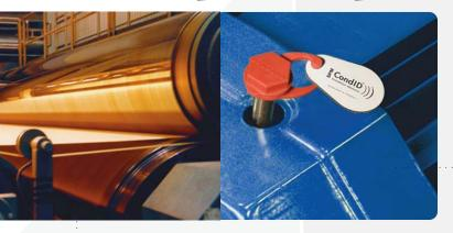
Identificación sin contacto de los puntos de medición con el CondID® Memoria de la condición patentado por SPM.
