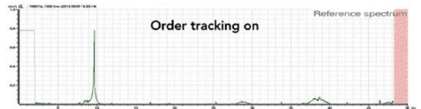
La misma máquina medida con Order Tracking activada, con variación de rpm del 10% (550-600 rpm) durante el tiempo de recogida de datos.
