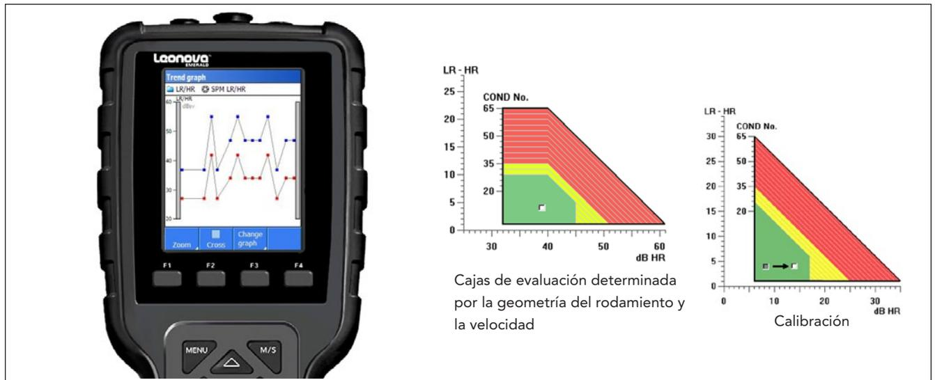
El método LR/HR fue desarrollado desde el original Método de Impulsos de Choque para el diagnóstico de la condición de los rodamientos. Permite un análisis preciso de la condición de la película del lubricante en la interfaz del rodamiento y contiene modelos de cálculo para encontrar el lubricante óptimo. Una pobre lubricación es la causa origen de la mayoría de los fallos de los rodamientos.
