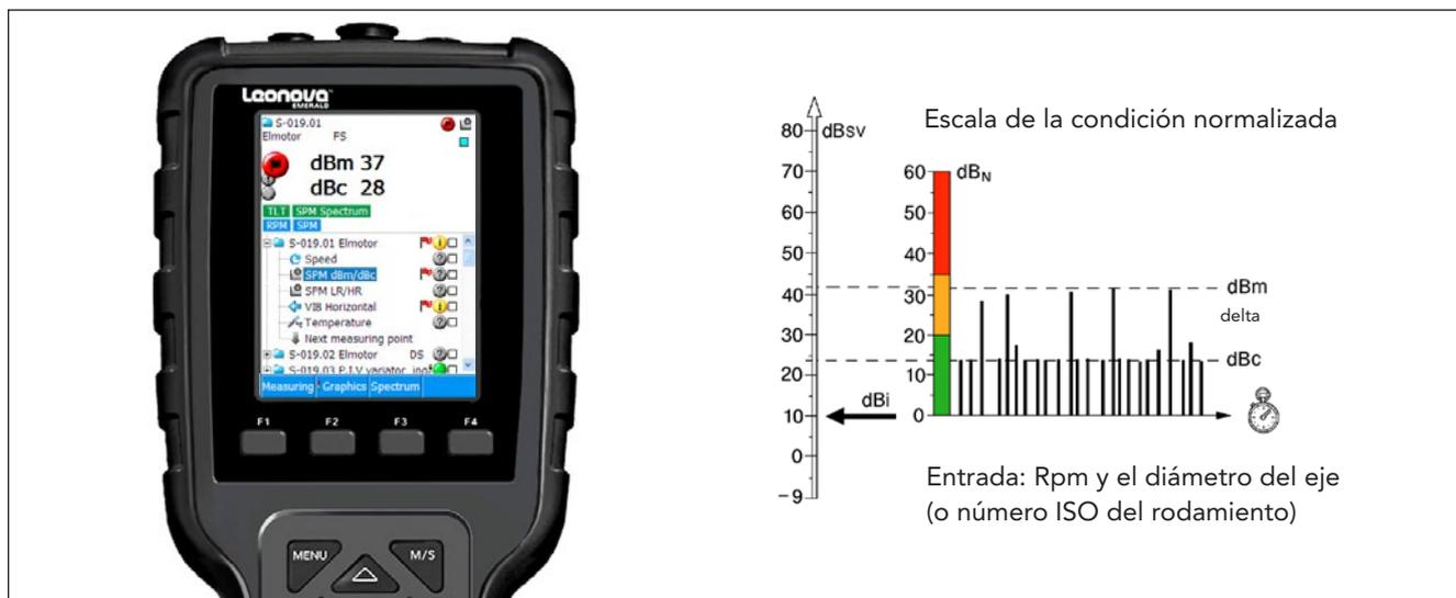
Por más de 40 años, el Método de Impulsos de Choque (SPM) se ha utilizado con gran éxito para obtener un EMEg-nóstico rápido, fácil y fiable sobre la condición de funcionamiento de los rodamientos.
