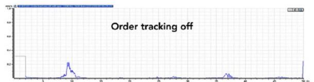
Las mediciones con Order Tracking no activada en una máquina con variación de rpm del 10% (550-600 rpm) durante el tiempo de recogida de datos.
